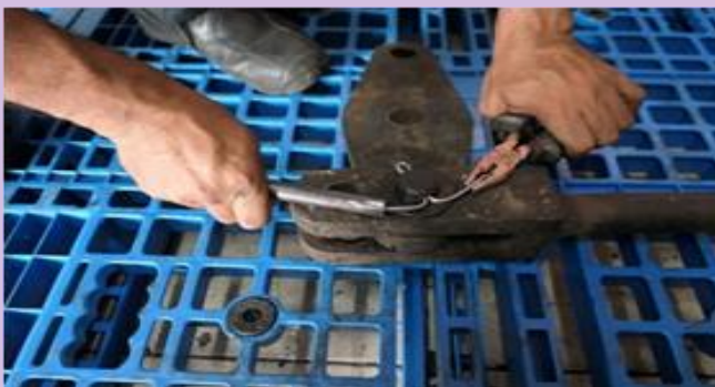
Gambar 4. Pemasangan komponen cotter pin/split pin pada komponen center pin di depo perawatan gerbong PT. KAI (Persero) dan pemasangan komponen cotter pin/split pin pada center pin di PT. INKA (Persero)
