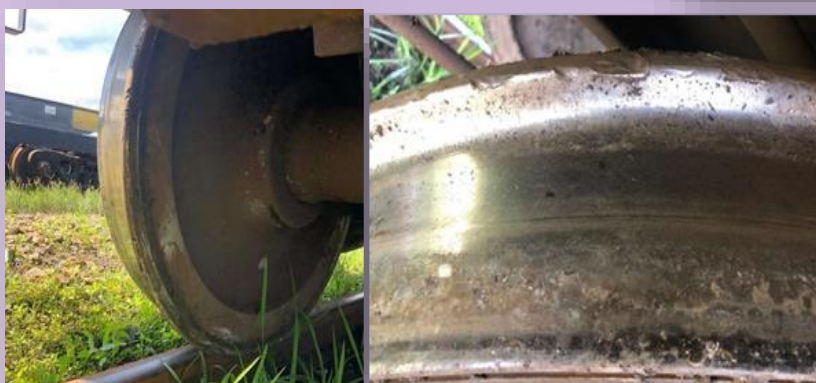
Gambar 4. Kondisi flens roda GB 50514 222 (gerbong ke 30) setelah anjlokkan
