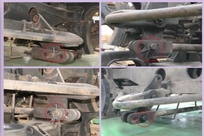
Gambar 3. Variasi pemasangan dari komponen cotter pin/split pin pada komponen connecting
