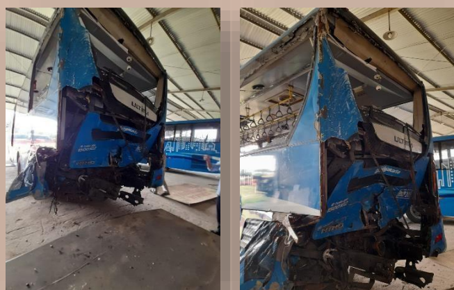
Gambar 2. Bodi Bus 2 Bagian Belakang Terdeformasi
