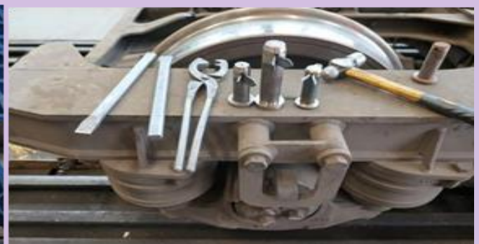
Gambar 4. Pemasangan komponen cotter pin/split pin pada komponen center pin di depo perawatan gerbong PT. KAI (Persero) dan pemasangan komponen cotter pin/split pin pada center pin di PT. INKA (Persero)
