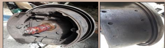
Gambar 2. Komponen rem di roda terpasang, permukaan gesekan kampas rem
